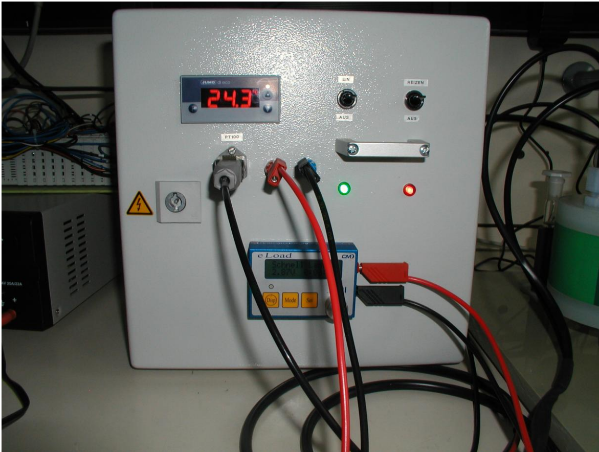
Abbildung 1: Laden der elektrischen Last über den Heizkreislauf
