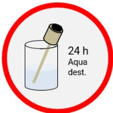
Stellen Sie die Mini-HydroFlex für 24 Stunden in destilliertes Wasser.
