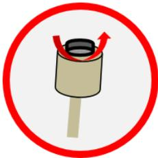
Drehen Sie die Verschlusskappe heraus und entfernen Sie die Wasserstoffzelle.
