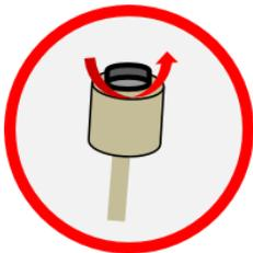
Drehen Sie die schwarze Kappe heraus und entfernen Sie die Wasserstoffzelle.
