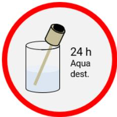
Stellen Sie die Mini-HydroFlex für 24 Stunden in Wasser.
