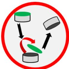
Nehmen Sie die Wasserstoffzelle zur Hand und entfernen Sie die Schutzfolie. Es werden zwei Öffnungen sichtbar. Falls Klebereste zurückbleiben, entfernen Sie diese durch Abreiben mit einem Tuch.
