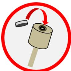
Legen Sie die Wasserstoffzelle mit diesen beiden Öffnungen nach unten in die Vertiefung.
