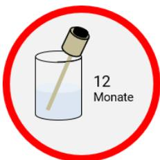
Sobald die Laufzeit von 12 Monaten erreicht wird, muss umgehend die Wasserstoffzelle ausgetauscht werden (siehe 4. Wartung). Andernfalls bildet sich ein Unterdruck in der Kapillare, so dass Flüssigkeit in die Kapillare gelangen kann.
