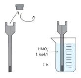
Entfernen Sie die Wasserstoffquelle. Stellen Sie die Wasserstoffelektrode für 1h in 1 mol/l Salpetersäure.
