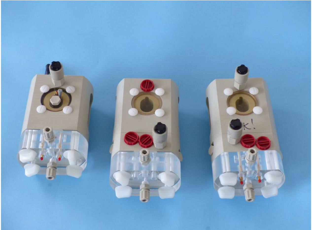
**Abbildung 5:** Links Normale Zelle. In der Mitte eine Zelle mit Membran, die Anolyt und Katholyt trennt und der passenden Position der Referenz zur Messung der Arbeitselektrode. Rechte Zelle eine Zelle mit Membran sowie zwei Referenzelektroden, die den Spannungsabfall über der Membran messen.
