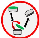
Nehmen Sie die Ersatzwasserstoffzelle zur Hand und entfernen Sie die Schutzfolie. Es werden zwei Öffnungen sichtbar. Falls Klebereste zurückbleiben, entfernen Sie diese durch Abreiben mit einem Tuch.
