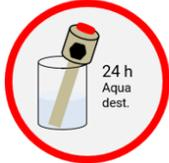
Stellen Sie die Wasserstoff-pH-Elektrode für 24 Stunden in destilliertes Wasser.
