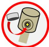
Legen Sie jeweils eine Wasserstoffzelle mit diesen beiden Öffnungen nach innen in die Vertiefung.
