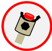
Bitte drehen Sie zunächst die rote Verschlusskappe am Elektrodenkopf heraus.
