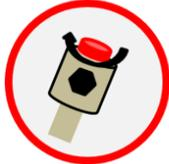
Drehen Sie das rote Überdruckventil wieder in den Elektrodenkopf hinein.
