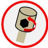
An den Seiten des Elektrodenkopfes befinden sich zwei schwarze Kappen. Bitte drehen Sie auch diese heraus. Nehmen Sie die Wasserstoffzellen heraus.
