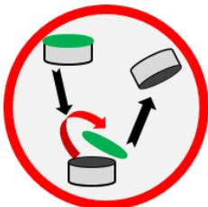
Nehmen Sie eine neue Wasserstoffzelle zur Hand und entfernen Sie die Schutzfolie. Es werden zwei Öffnungen sichtbar. Falls Klebereste zurückbleiben, entfernen Sie diese durch Abreiben mit einem Tuch.
