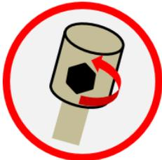
An den Seiten des Elektrodenkopfs befinden sich zwei Verschlusskappen. Bitte drehen Sie diese auch heraus. Nehmen Sie die darunterliegenden Wasserstoffzellen heraus.
