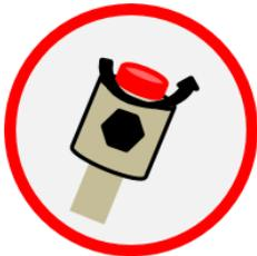
Bitte drehen Sie zunächst das rote Überdruckventil am Elektrodenkopf heraus.
