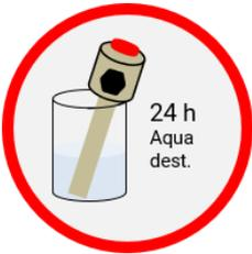
Stellen Sie die Wasserstoff-pH-Elektrode für 24 Stunden in destilliertes Wasser.
