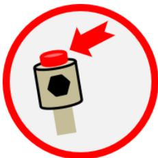
pHydrunio ist bereits mit Innenelektrolyt gefüllt. Tauschen Sie den roten Transportstopfen im Elektrodenkopf durch das beiliegende rote Überdruckventil aus, das zugleich Verschlusskappe ist.
