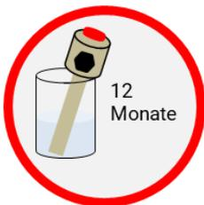
Sobald die Laufzeit von 12 Monaten erreicht wird, müssen die Wasserstoffzellen umgehend ausgetauscht werden (siehe 5. Wartung). Andernfalls bildet sich ein Unterdruck in den Kapillaren, so dass Flüssigkeit in die Kapillaren gelangen kann.
