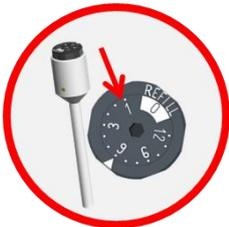
Oben am Elektrodenkopf drehen Sie mit einem 3 mm Sechskantschlüssel die Laufzeit im Uhrzeigersinn auf Stellung 1, das entspricht 1 Monat.
